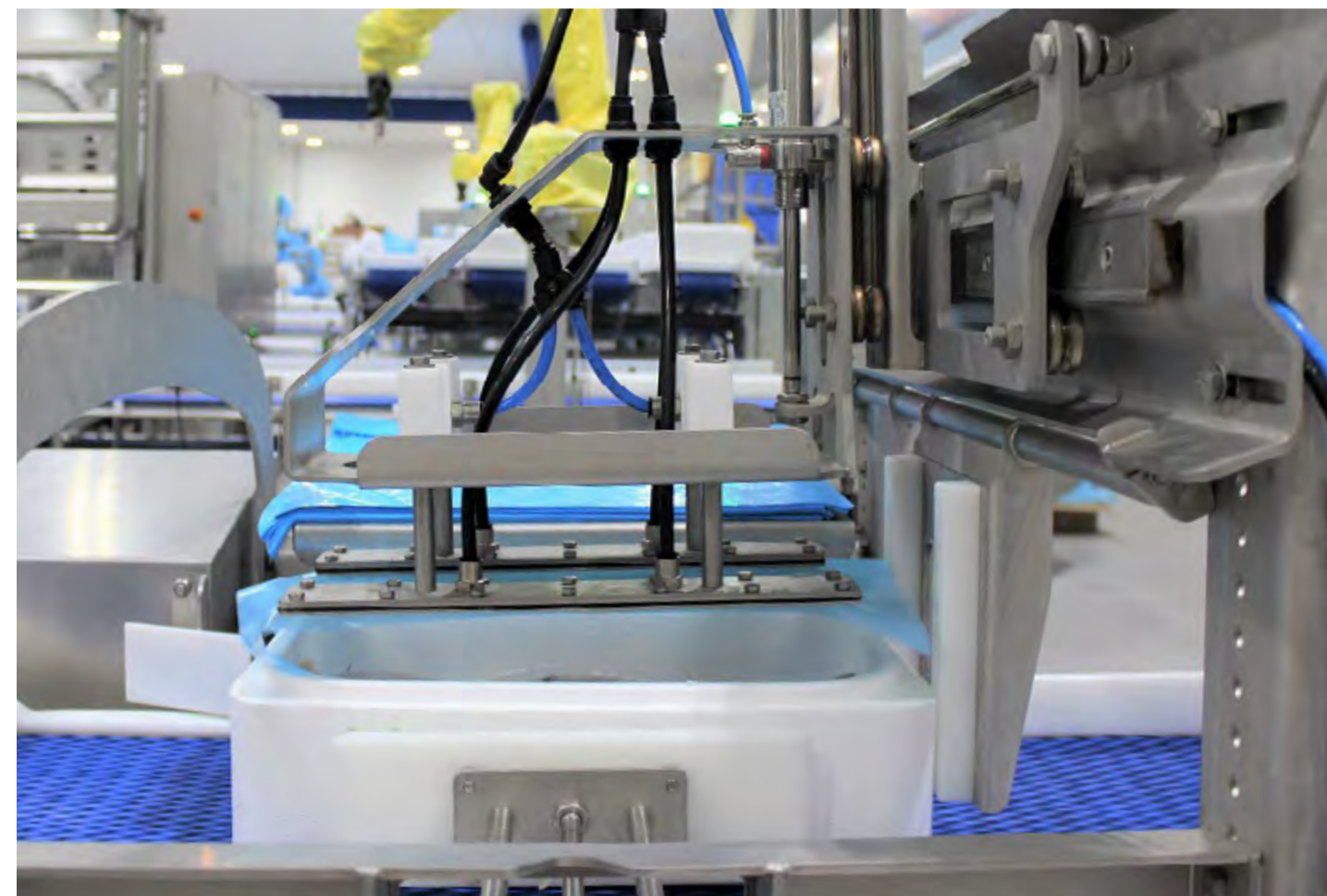
Tækniteymi landvinnslu Samherja þróaði lausn sem setur plastfilmur ofan í öskjur með afurðum áður en þeim er lokað.
